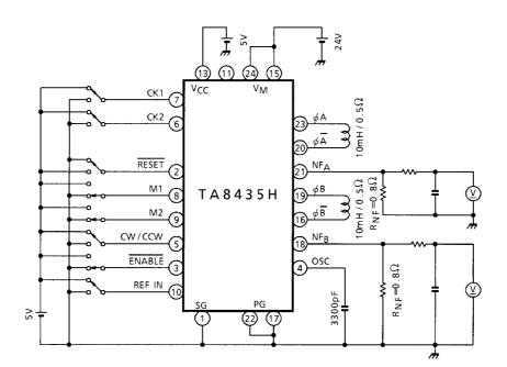
TEST CIRCUIT 4  $V_{CE (SAT)}$  UPPER SIDE, LOWER SIDE
