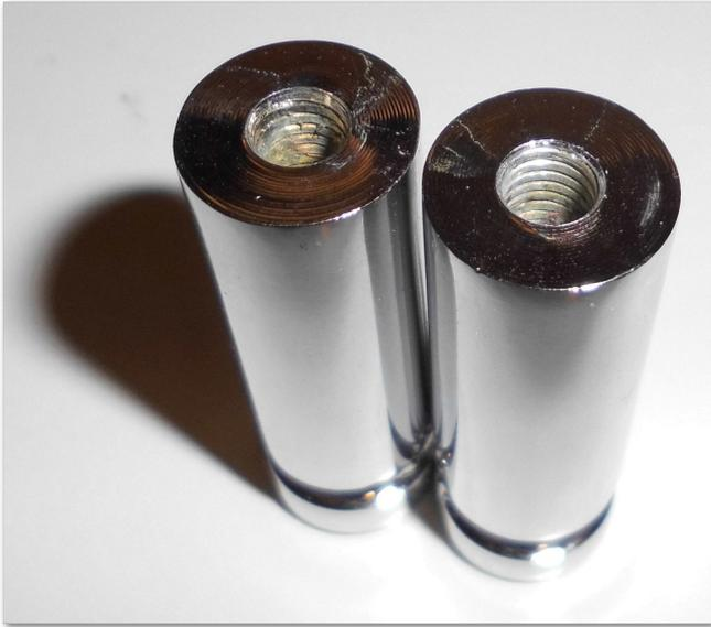
Beide Gewinde sind zu groß, defekt, und die Chromschicht auf den Gewinden ist n.i.O.
