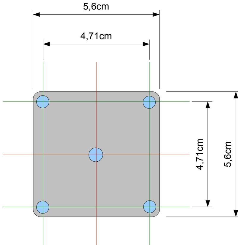
Das Blatt ausdrucken, die graue Schablone ausschneiden, mit einem Körner ankörnen mit Klebefilm aufkleben und dann erst ganz fein vorbohren, danach erst auf Maß aufbohren.
